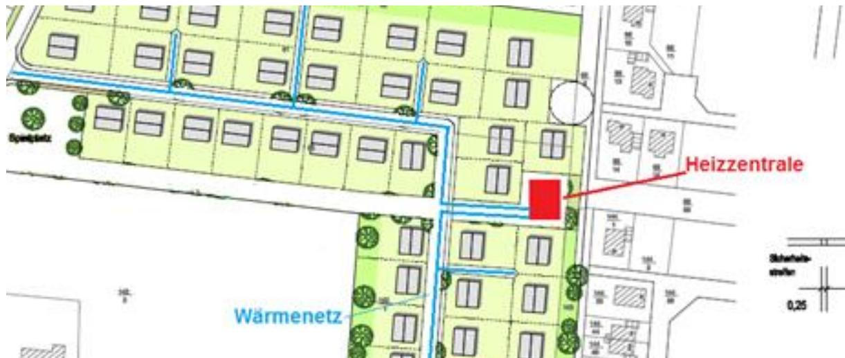
Um die dortigen Wohnhäuser jederzeit ausreichend und sicher mit Energie für die Beheizung und für die Warmwasserbereitung zu versorgen, wird in der Energiezentrale ein erdgasbetriebenes Blockheizkraftwerk (BHKW) mit 40 kW thermischer Leistung und 20 kW elektrischer Leistung installiert.
